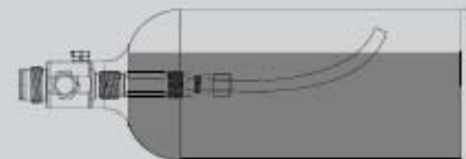
FIG.5 → CO 2 С АНТИ-СИФОННОЙ ТРУБКОЙ [В РАЗРЕЗЕ]
